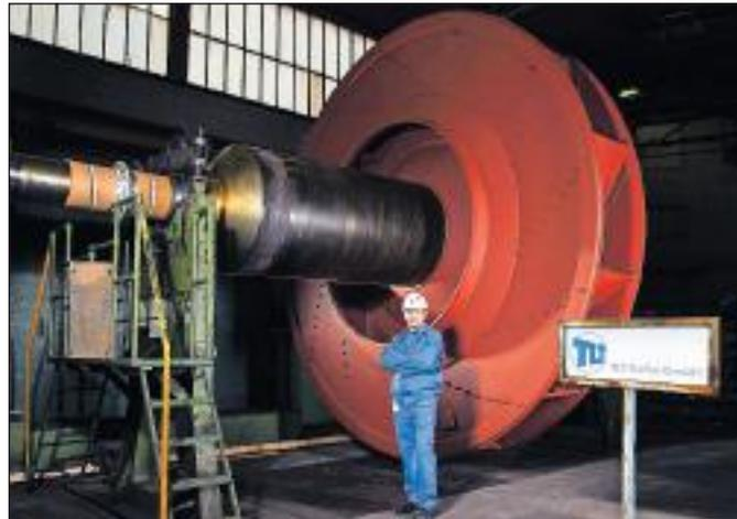
**Wirkt in China: das Unternehmen TLT Turbo. Radialventilatoren aus der Zweibrücker Schmiede sorgen für konstanten Saugdruck im größten Stahlwerk Chinas.** FOTO: CHRIS ERMKE MEDIA OBERHAUSEN/FREI
