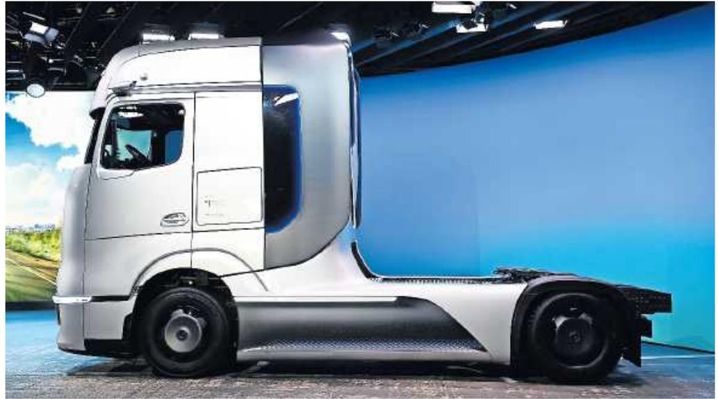
**Ein Prototyp eines Lasters, wie ihn Daimler vorgestellt hat. Er fährt mit Strom aus Wasserstoff. Die Technologie will der Kaiserslauterer „Blue Corridor“ beispielsweise für die Flotte der Abfallverwertung nutzen.**
